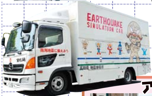
【地震体験車(起震車)】 日野 BDG-FC7JHWA/ エンジン-J07E 6.4Lディーゼル●架装部分 (株)アスカアイテック社製
